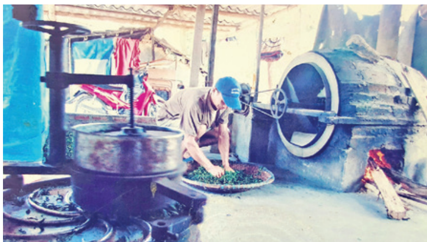
Phương pháp xao chè thủ công bằng than, củi trước đây
