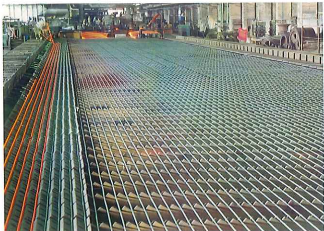
Thép cán ra sàn nguội, Nhà máy Luyện cán thép Gia Sàng
