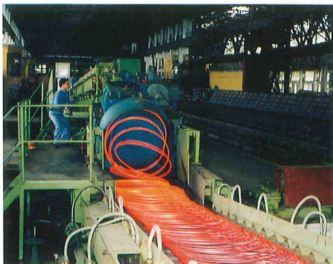
Dây chuyên sản xuất thép cuộn \Phi 6 , \Phi 8 , Nhà máy Cán thép Lưu Xá
